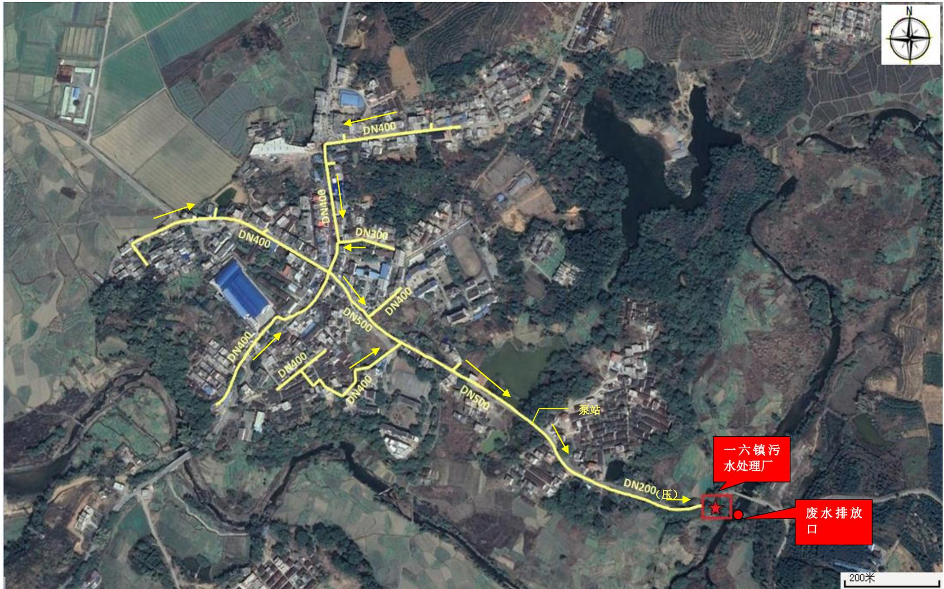
图4 一六镇污水处理厂配套管网路线示意图
