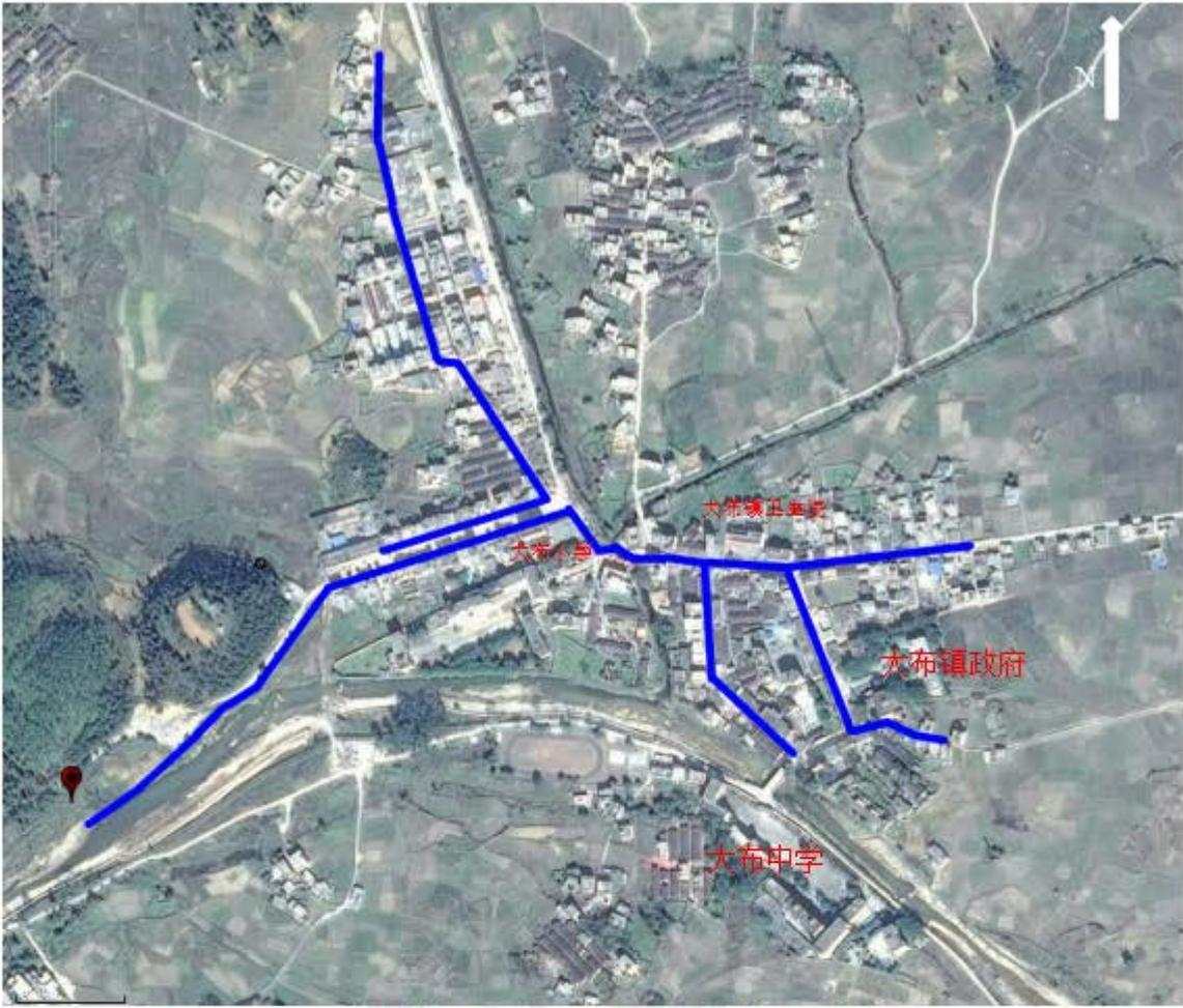
图 4 大布镇污水处理厂配套管网路线图
