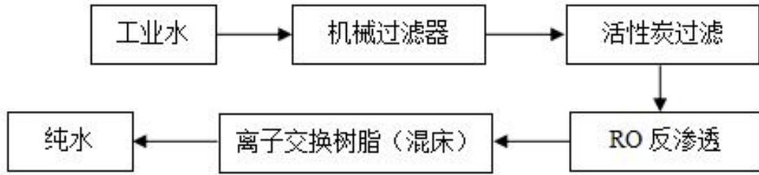
图 3.7-4 纯水制备系统工艺流程
