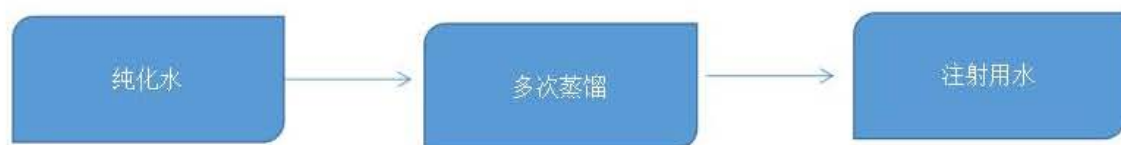
图16 注射用水制备生产工艺流程及产污节点图
