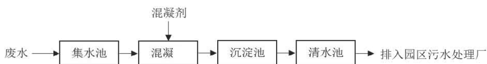
图 20 项目污水池预处理工艺流程图
