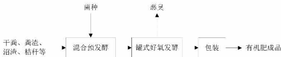
图 2.2-5 粪渣等制作有机肥料工艺
