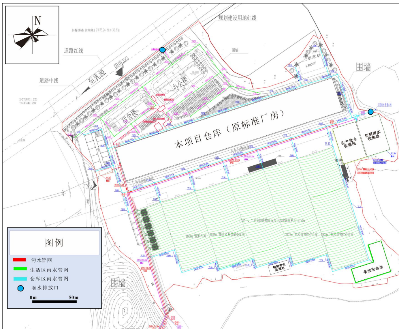
图4 项目区雨污管网走向图
