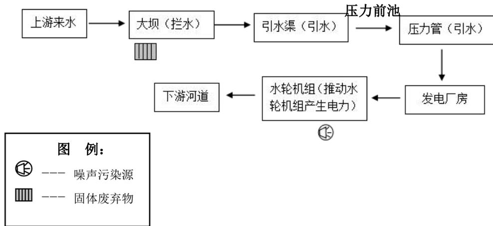
图 2-1 水电站工艺流程及产污节点图
