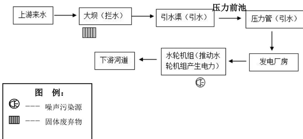
图 2-1 水电站工艺流程及产污节点图
