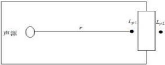
图 4-1 室内声源等效为室外声源图例
