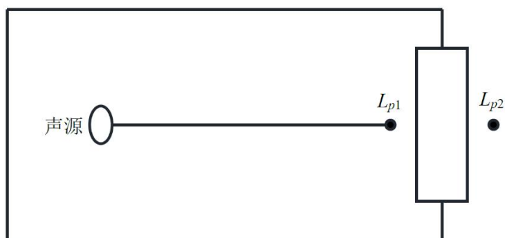
图 2 室内声源等效为室外声源图例
