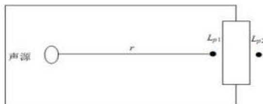
图 4-1 室内声源等效为室外声源图例
