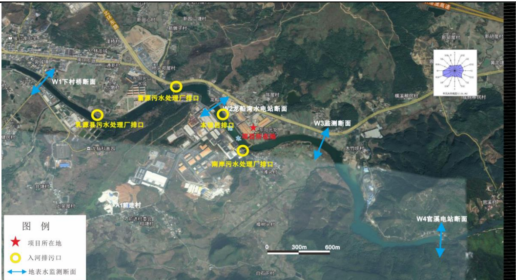
图 3-3 地表水水质断面布设图
