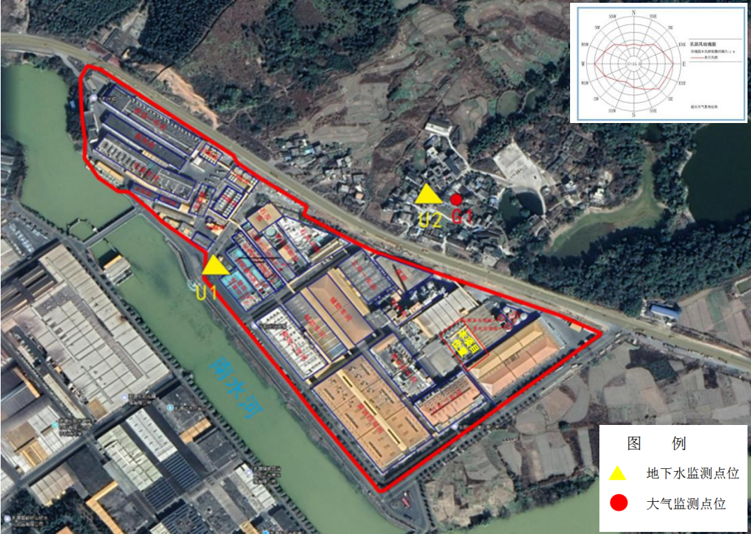
图 3-1 地下水、环境空气采样点位示意图
